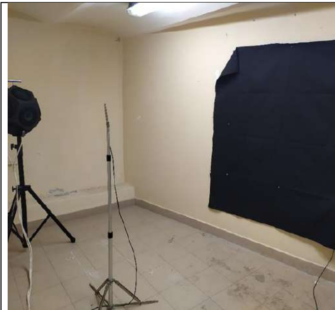
Рисунок 3.16 – Один из вариантов расположения опытного образца в реверберационной камере
